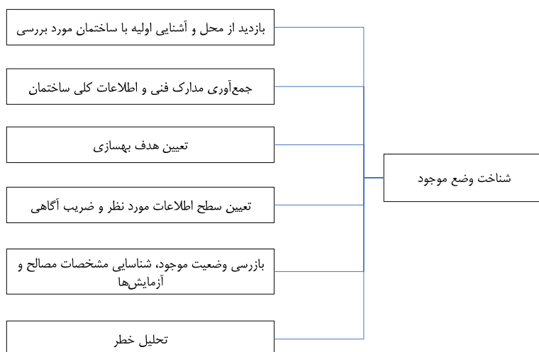
شکل (۱-۱): مراحل شناخت وضع موجود
